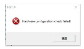
1. 检查 TestUI -> Options 下是否开启 Enable Hardware Configuration Check,若开启则会对当前测试机内的配置和程序中 HardwareCfg()函数中的配置进行检查,若当前测试机内的配置少于 HardwareCfg()中的配置,则会报错。若只是调试阶段,可将该选项屏蔽。
